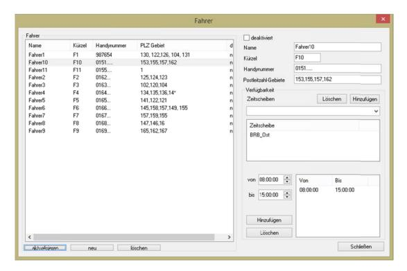
Im Ergebnis werden für Touren mit mindestens einer übereinstimmenden PLZ, Verfügbarkeit des Fahrers vorausgesetzt, Fahrer und Fahrzeug automatisch zugewiesen. Der Planungsaufwand reduziert sich dadurch erheblich.
